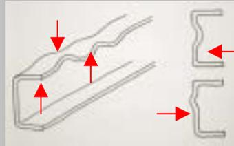
上下面フランジの変形・側面ウェブの変形を足踏み操作のエア駆動油圧ポンプとC型プレスを用いて修理します。 \*専用エアポンプ使用
